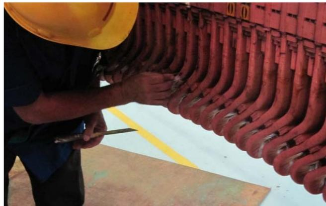
FIGURA 9 – Intervenção nos enrolamentos do estator.
