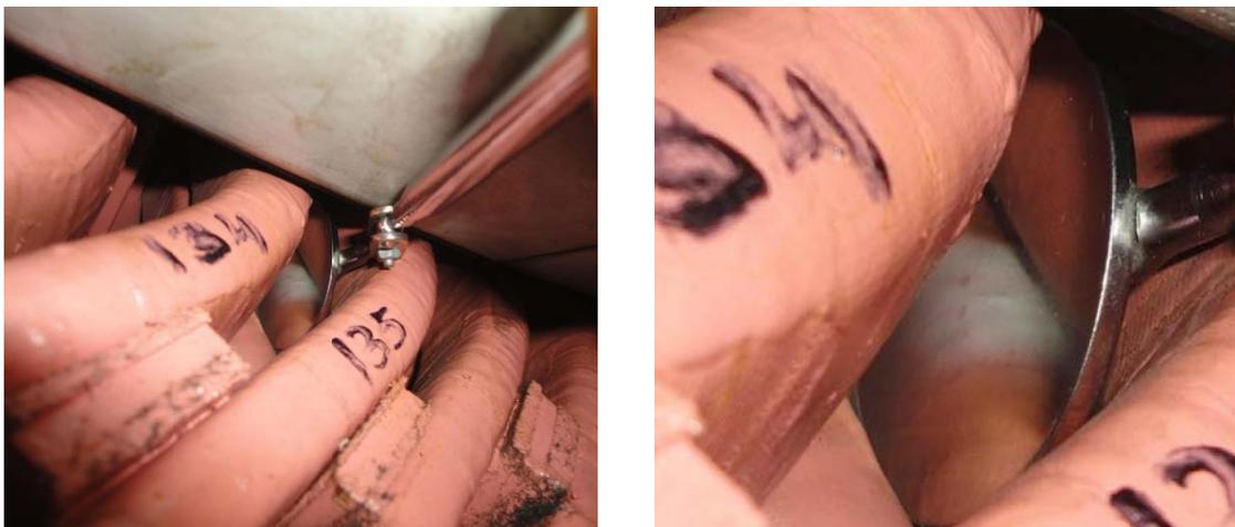
FIGURA 7 - Barra de fundo da ranhura 134 apresenta sinal de aquecimento da pintura de acabamento da superfície provocado possivelmente por efeito corona.
